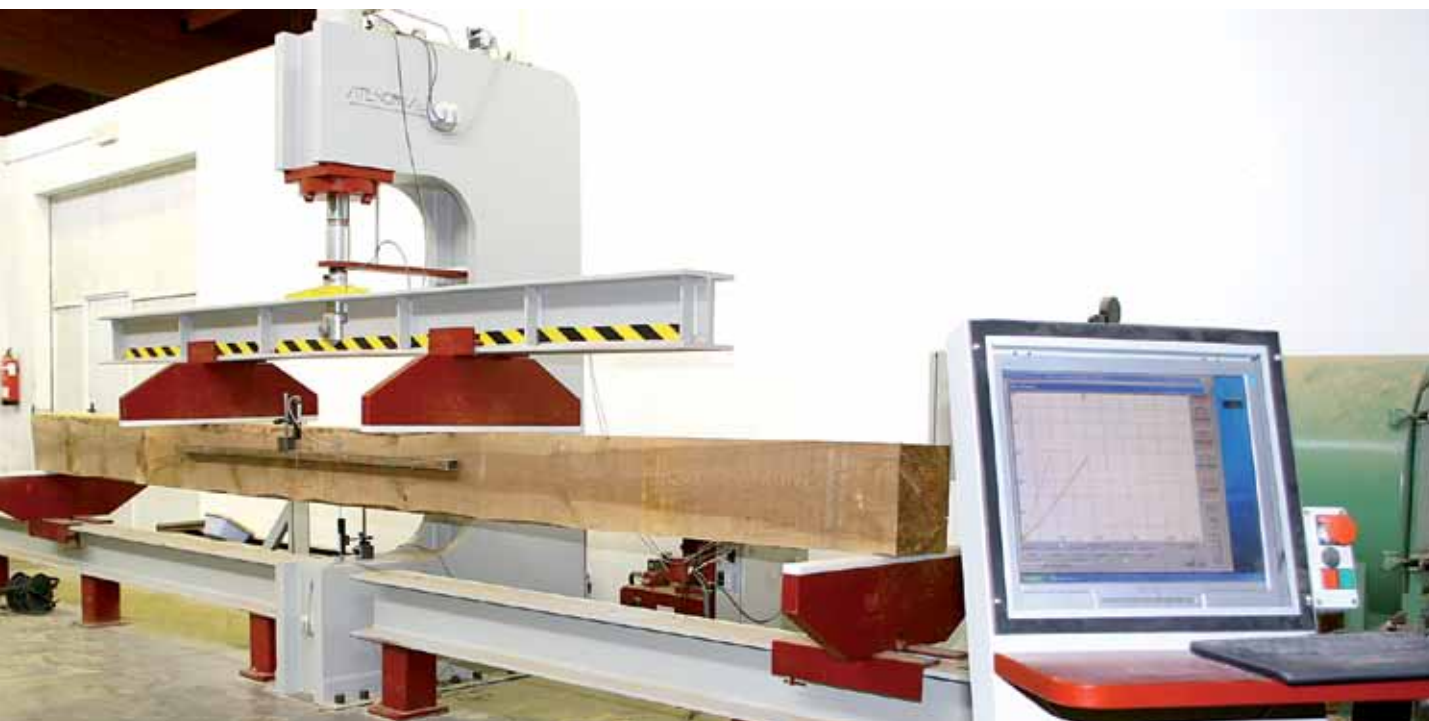
Proceso de ensayo de una viga.
