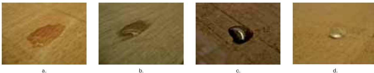
Imagen 2. Color de la madera de haya natural (a), tratada en autoclave y tratada mediante sustitución de savia (b), termotratada (c) y tratada mediante nanopartículas (d)
