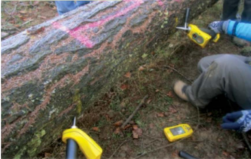
Ensayo no destructivo con equipo HM 200 (Fibergen)
