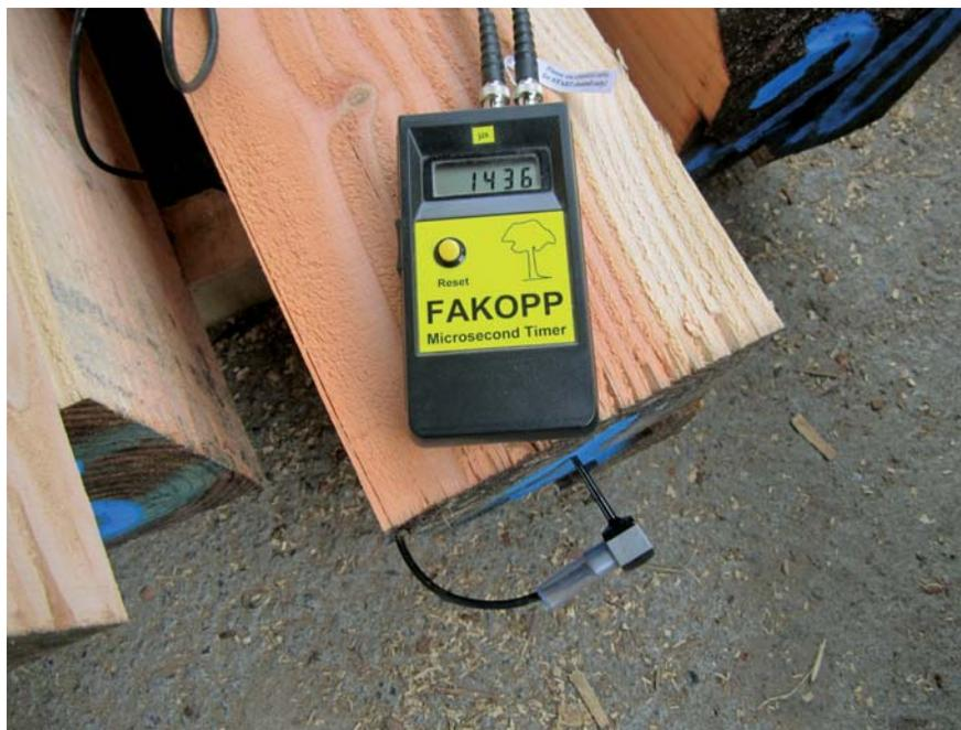
Ensayo no destructivo con equipo Microsecond Timer (Fakopp) en viga
