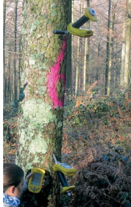
Ensayo no destructivo con equipo HM3 (Fibergen)
