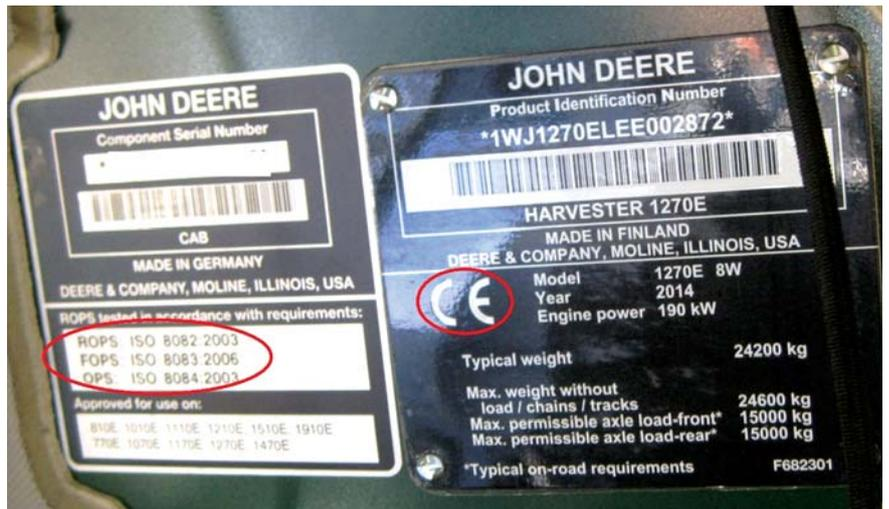
Placa con marcado CE y con Indicación de sistemas de protección ROPS, FOPS y OPS
