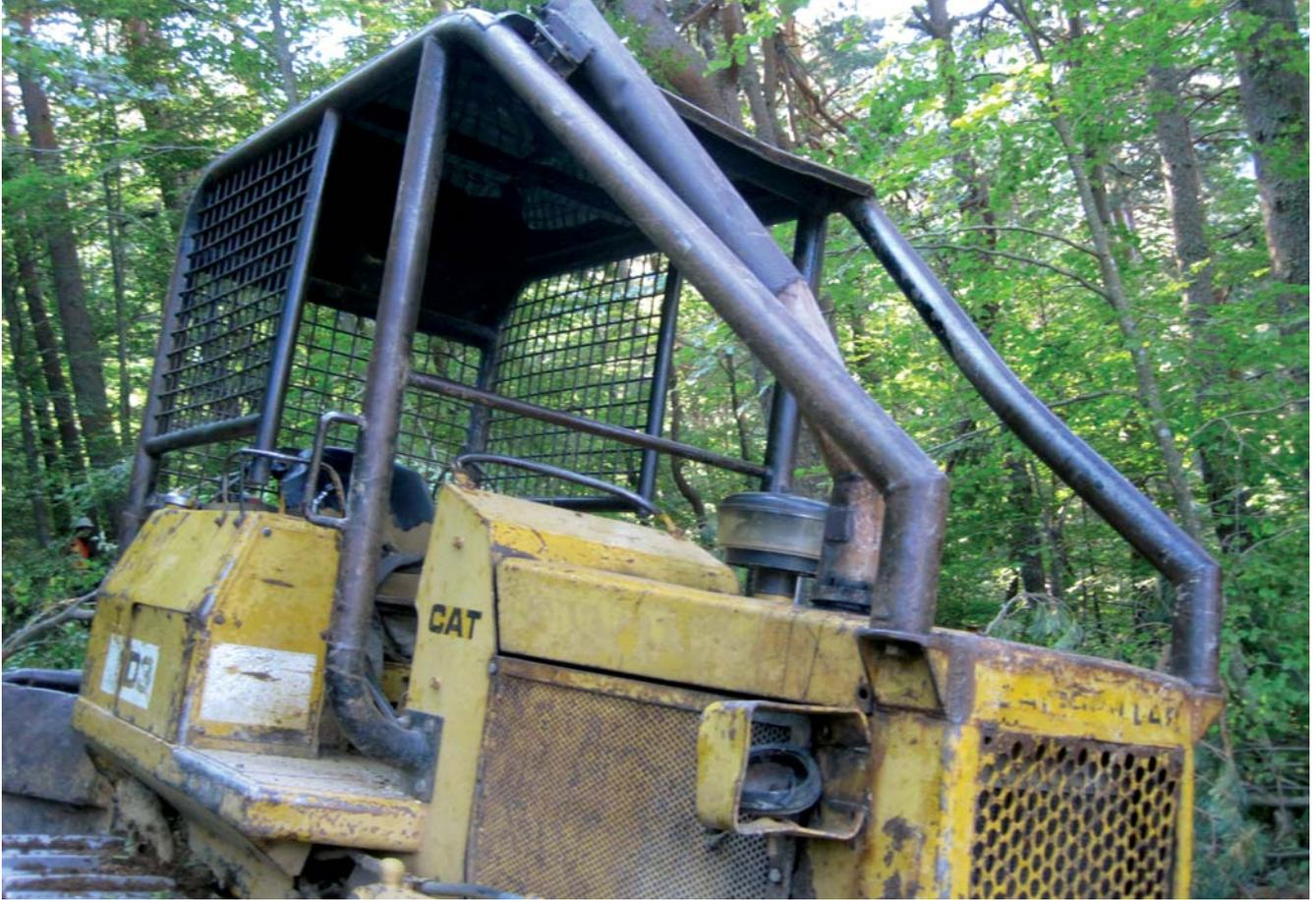
Maquinaria con Marcado CE y sistemas de protección ROPS, FOPS y OPS
