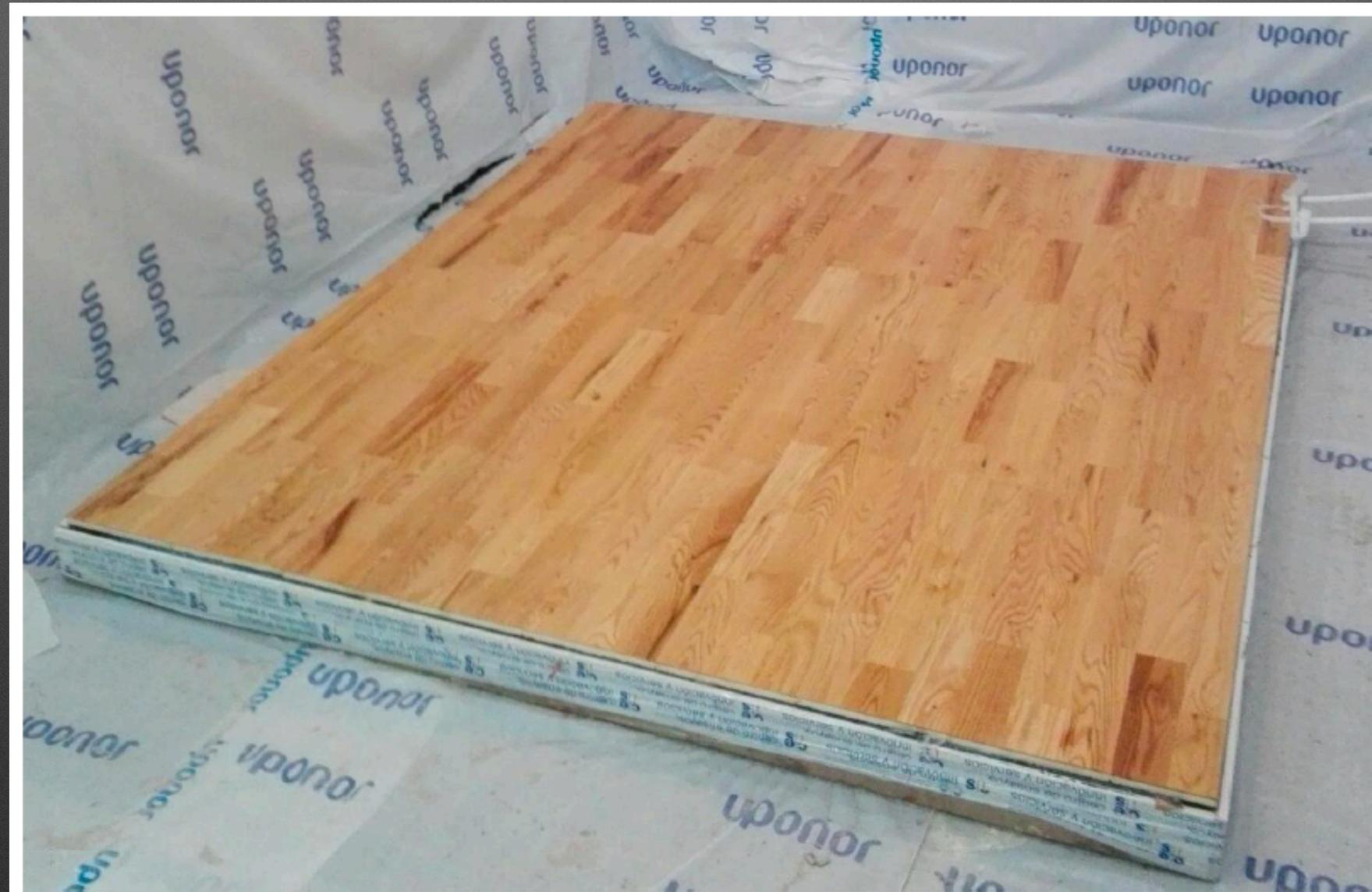
Probeta. Instalación de la madera
