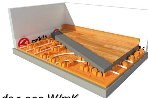
$R_{\lambda,B} = 0,10 \text{ m}_2\text{K/W}$   $\lambda_E = 1,2 \text{ W/mK}$   $\lambda_R = 0,350 \text{ W/mK}$   $D_a = 0,016 \text{ m}$   $S_r = 0,002 \text{ m}$   $S_{U,0} = 0,045 \text{ m}$   $\vartheta_i = 20 \text{ }^\circ\text{C}$
