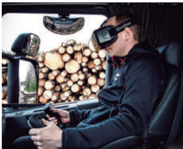
Sistema de realidad aumentada para manejo de grúas forestales desde la cabina del camión.
