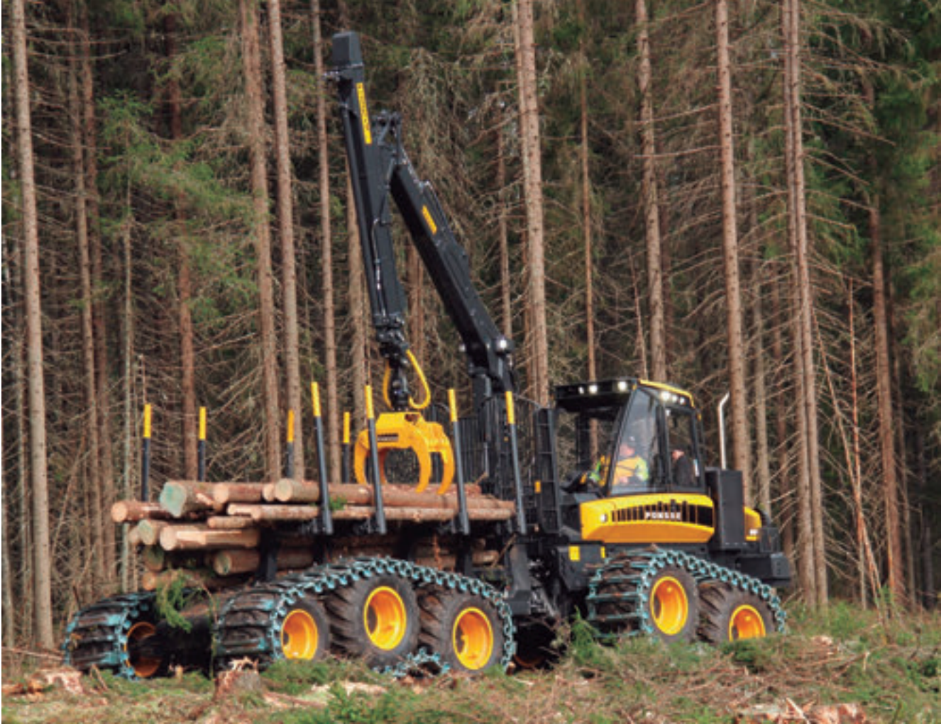
Autocargador PONSSE con eje auxiliar al Bogie trasero para mejorar la tracción y evitar erosiones en terrenos blandos.
