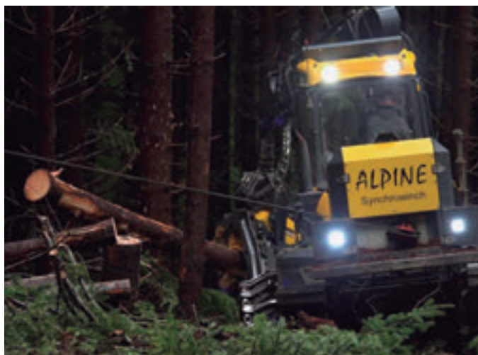
Procesadora PONSSE con sistema SynchroWinch de asistencia a la tracción para trabajo en pendientes.
