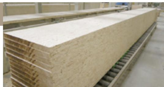
Se obtienen aplicando presión y calor a virutas de madera encoladas.
