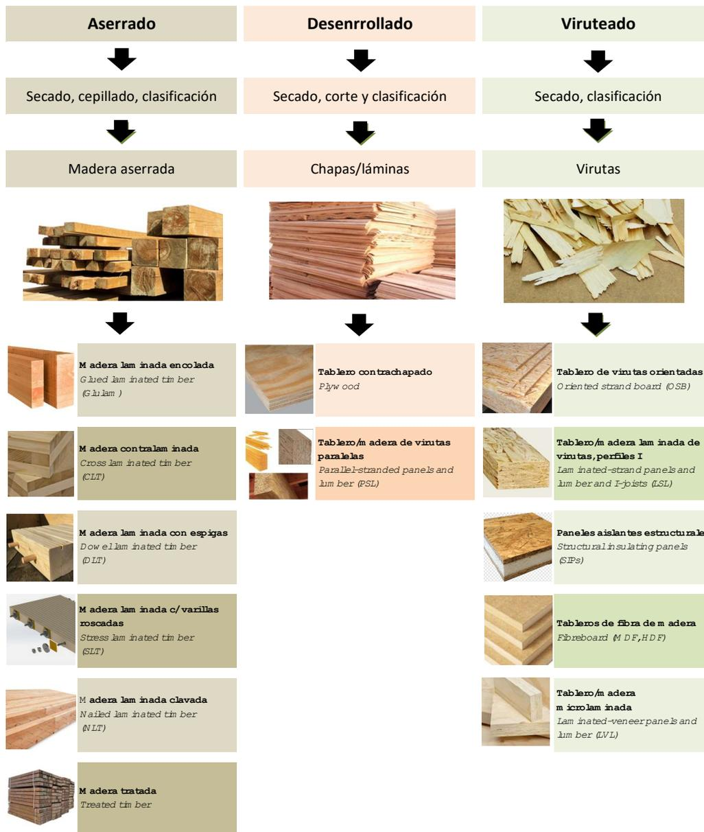
Figura 2. Productos de la madera según su proceso de transformación. Adaptación propia en base a *The wood from the trees: The use of timber in construction*, Ramage [8].
