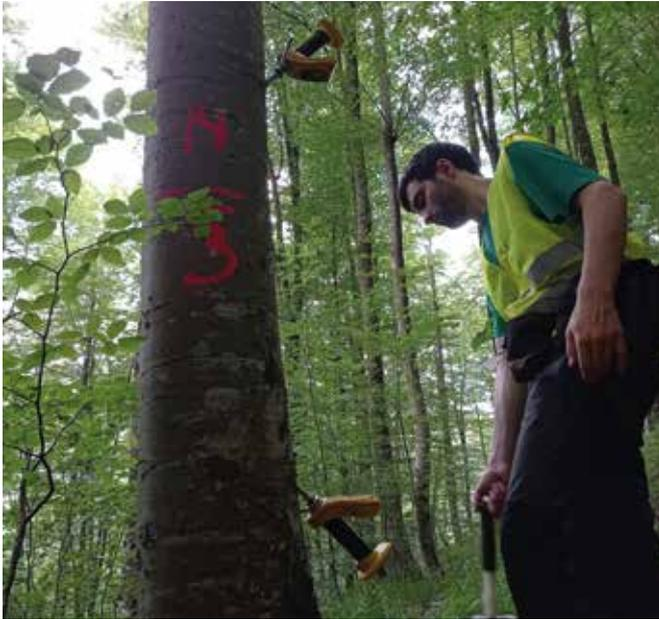
Fig. 2. Medición de la velocidad de propagación de una onda de impacto a lo largo del fuste.
