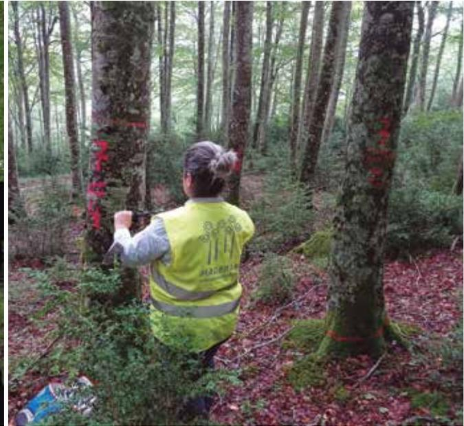
Fig. 4. Extracción de muestra de madera con barrena de Pressler.
