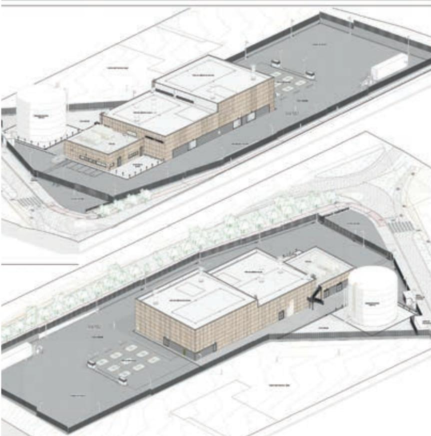
Vistas 3D de la central de calor que producirá de manera centralizada agua caliente para cubrir la demanda de calefacción y agua caliente sanitaria de más de la mitad de las viviendas del barrio, 2.200 en la primera fase de desarrollo, actualmente en ejecución, y otras 2.300 en la segunda.
